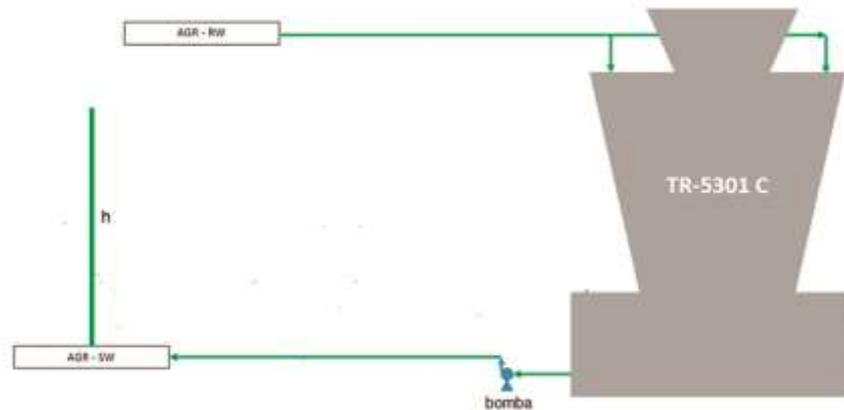
Uma torre de resfriamento tem a função de realizar, como o próprio nome diz, o resfriamento durante os processos produtivos industriais. Ela é responsável por realizar a remoção do calor, realizando a transferência do calor residual para a atmosfera.
